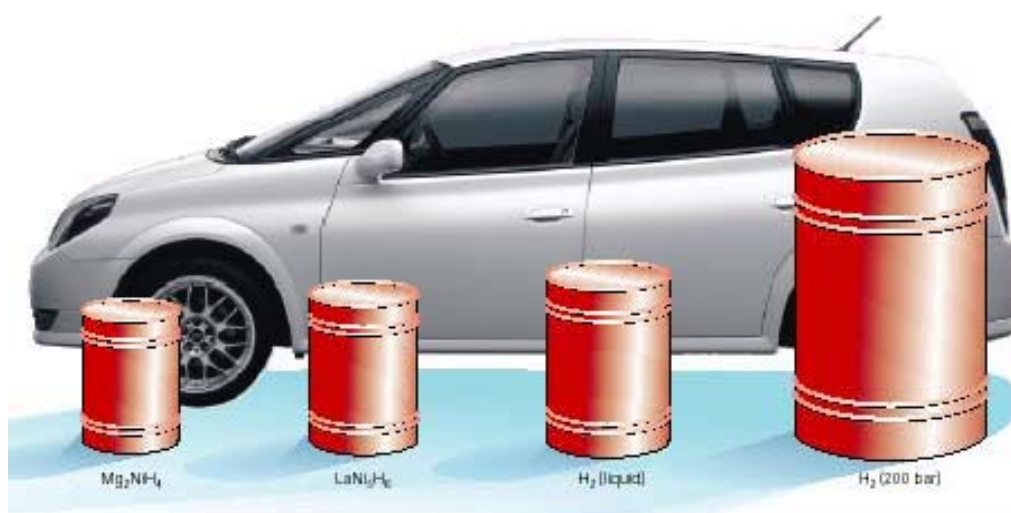
Figuur 1 Hydrogen storage materials for mobile applications , L. Schlapbach, A. Züttel, Nature , 414 2001 353-358, van rechts naar links: gecomprimeerd, vloeibaar, zwaar hydride \text{LaNi}_5\text{H}_6 , licht hydride \text{Mg}_2\text{NiH}_4
